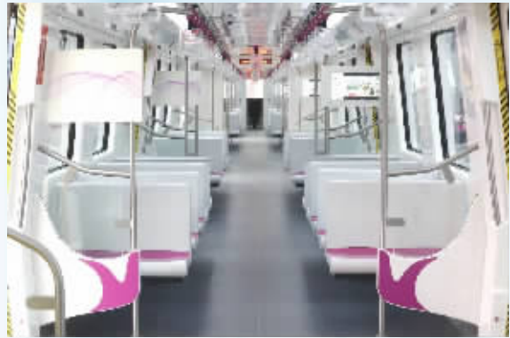
车内座椅采用横、纵交替布置
