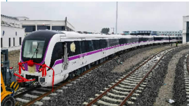
贵阳轨道交通S1线电客车为B2型列车,最高时速100公里,最大载客量2048人。 本报资料图片
